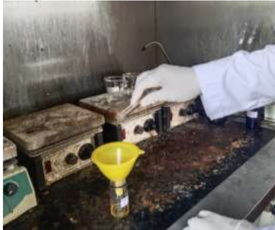
Gamabr 8: Proses Penyaringan sebelum diperiksa di spektrofotometer serapan atom
