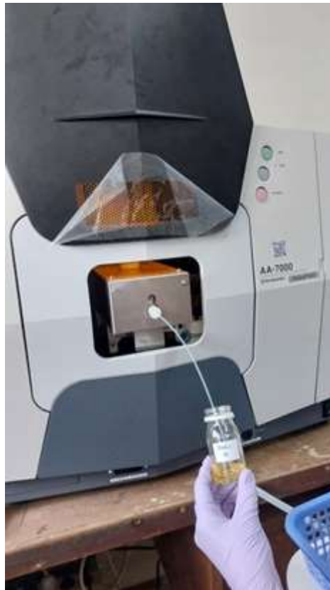
Gambar 9: Proses pembacaan di alat spektrofotometer serapan atom
